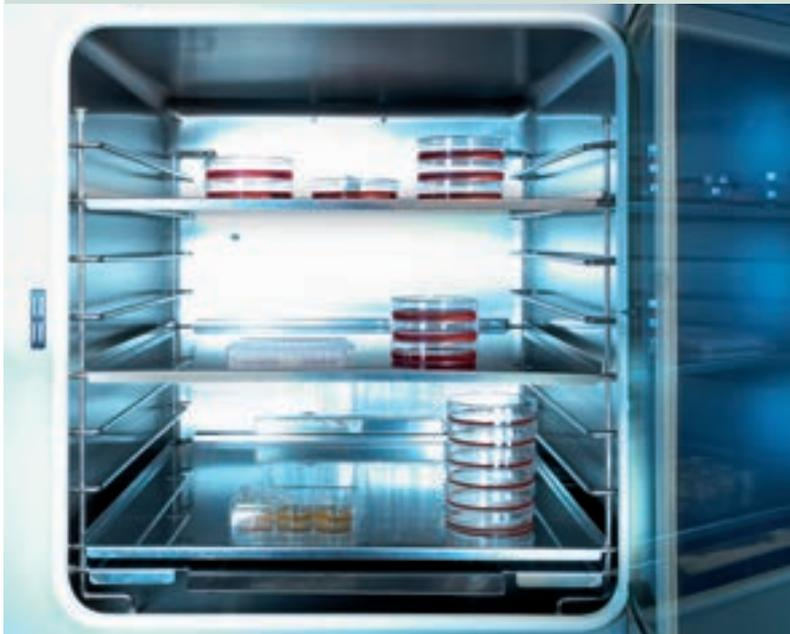
Der Inkubator ahmt die Bedingungen im Körper nach. Hier werden die Zellen bei einer konstanten Temperatur von 37°C und einem CO<sub>2</sub>-Gehalt von fünf Prozent in einem feuchten Milieu gehalten.
